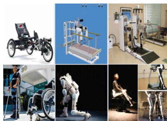
Slika 14. Robotizirani sustavi za rehabilitaciju (mobilni trener GT-I, Lokomat i AutoAmbulator) i novi robotski sustav (ReWalk i HAL)[24,25]4
