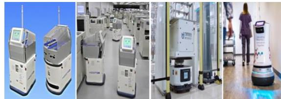
Slika 12. Robotski sistem za distribuciju uzoraka krvi u laboratoriju
