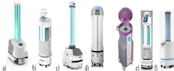
Slika 5. Različite konstrukcije servisnih robova za dezinfekciju sa UV svjetlošću
